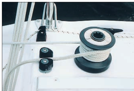
Кулачковые стопора смонтированы с ошибкой
